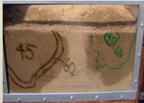
Vasemmalla hiekka on käsitelty Dispatchilla. Kuva osoittaa kuinka tehokkaasti se "imee" vettä maakerrokseen verrattuna ei käsiteltyyn alueeseen.
